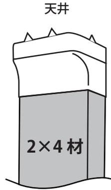
天井へ突っ張るときにエアースペーサーを刺して固定します。トゲによってがっちり固定され耐震性がUPします。
