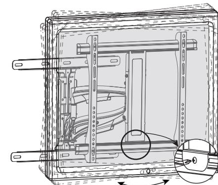
下部の**J** プレート結合ネジをゆるめると、水平調節が左右2度まで可能
