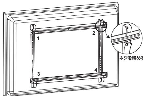
④**B-2** テレビ側取り付けブラケットに**J** プレート結合ネジ、ワッシャーで取り付けます。
