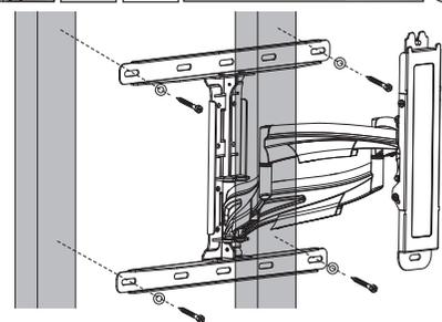
b. 補強壁に取り付けを行う場合は、**H** 壁側プレート用ラグボルト・ワッシャーを使用して4点~6点しっかりと止めてください。その際下記の穴の大きさと下穴を開けておくと取り付けがスムーズに行えます。
