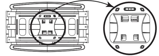
※水平調節はアームを折りたたんだまま行わないようにしてください。アーム部とブラケット取り付け部プレートが擦れ、塗装が剥がれてしまう場合がございます。調節を行う際には必ず少しアームを伸ばしてから調節してください。
