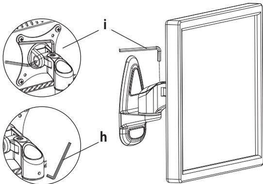
図の様に各可動部の六角穴にレンチ(h,i)を使って、角度の調節、固定を行います。
