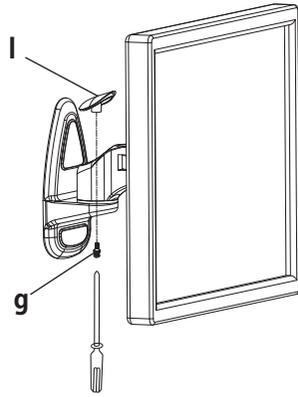
図の様にモニターブラケット(a)の窪みにプラスチックカバー(l)を取り付け、
