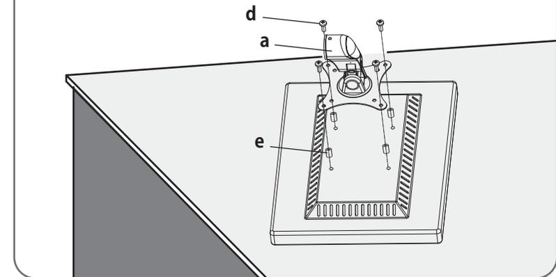
テレビに段差がある場合、テレビ背面のネジ穴にスペーサー(e)を合わせ、その上にモニターブラケット(a)を合わせ、ボルト(d)を4箇所ネジ止めします。
