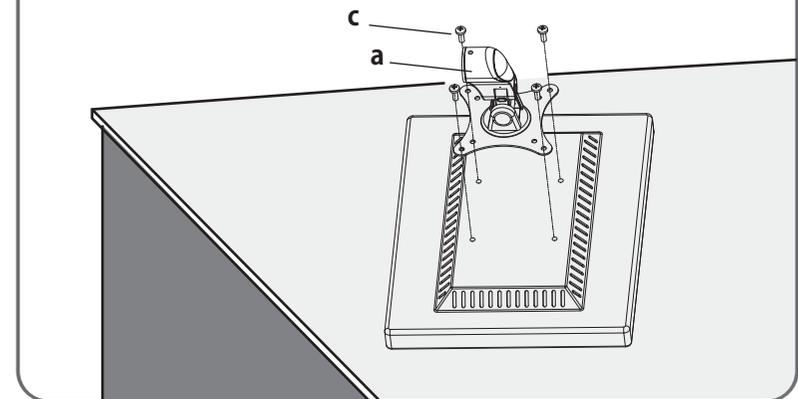
テレビ背面がフラットな場合、テレビ背面のネジ穴にモニターブラケット(a)を合わせ、ボルト(c)を4箇所ネジ止めします。
