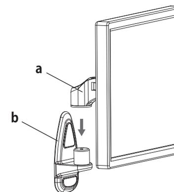
図の様に壁側プレート(b)の結合部にモニターブラケット(a)を組み合せてみます。
