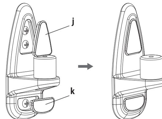
図の様に壁側プレート(b)の窪みにプラスチックカバー(j,k)を取り付けます。
