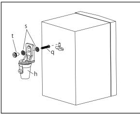
【キーホールタイプのスピーカーにご使用になる場合】 汎用ブラケット中央の穴にネジ(q)とサブナット(t)、 2個のワッシャー(s)を使ってスピーカーを固定して下さい。
