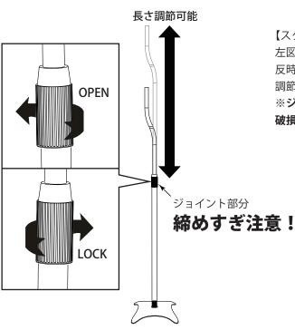
【スタンドパイプの長さを決め、固定する】 左図のようにスタンドパイプ (B) のジョイント部分を、 反時計回りに回転させることでお好みの長さに調節できます。 調節が出来たら時計回りに回してロックしてください。 ※ジョイント部分を強く締めすぎないでください。 破損の原因になります。
