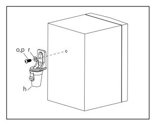
【ネジ穴 (M5) のスピーカーにで使用になる場合】 汎用ブラケット中央の穴にネジ (o または p) と ワッシャー (r) を使ってスピーカーを固定して下さい。
