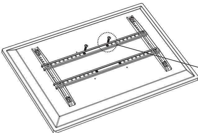
P.13 でテレビ側プレートに引っ掛けるため、5mm程度飛び出させます
