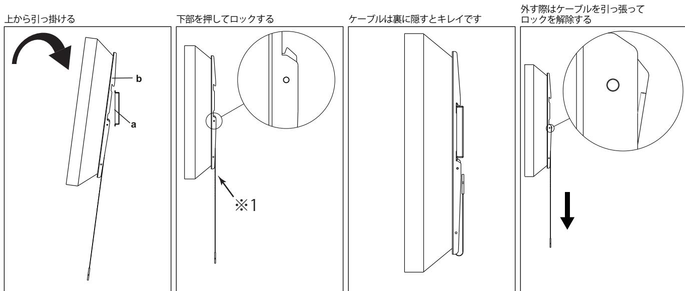
※1. テレビブラケットのロック部分が固くロックがかかりずらい場合はケーブルを下に引っ張るとロックが外れます。
