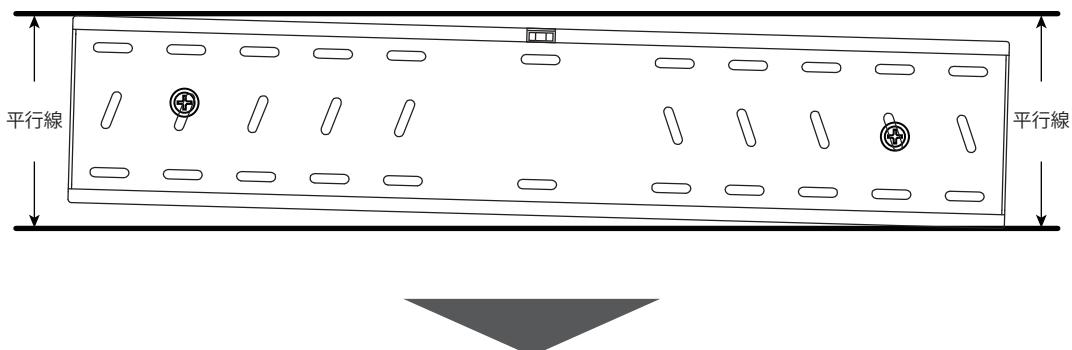
①壁側プレートに取り付けたネジを緩める
