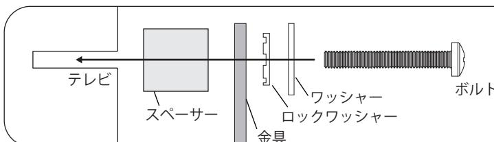
付属しているボルト類は基本的なものになります。取付けのテレビネジ穴の径や深さに合わない場合は別途適切なボルトをご用意の上お取り付けください。
